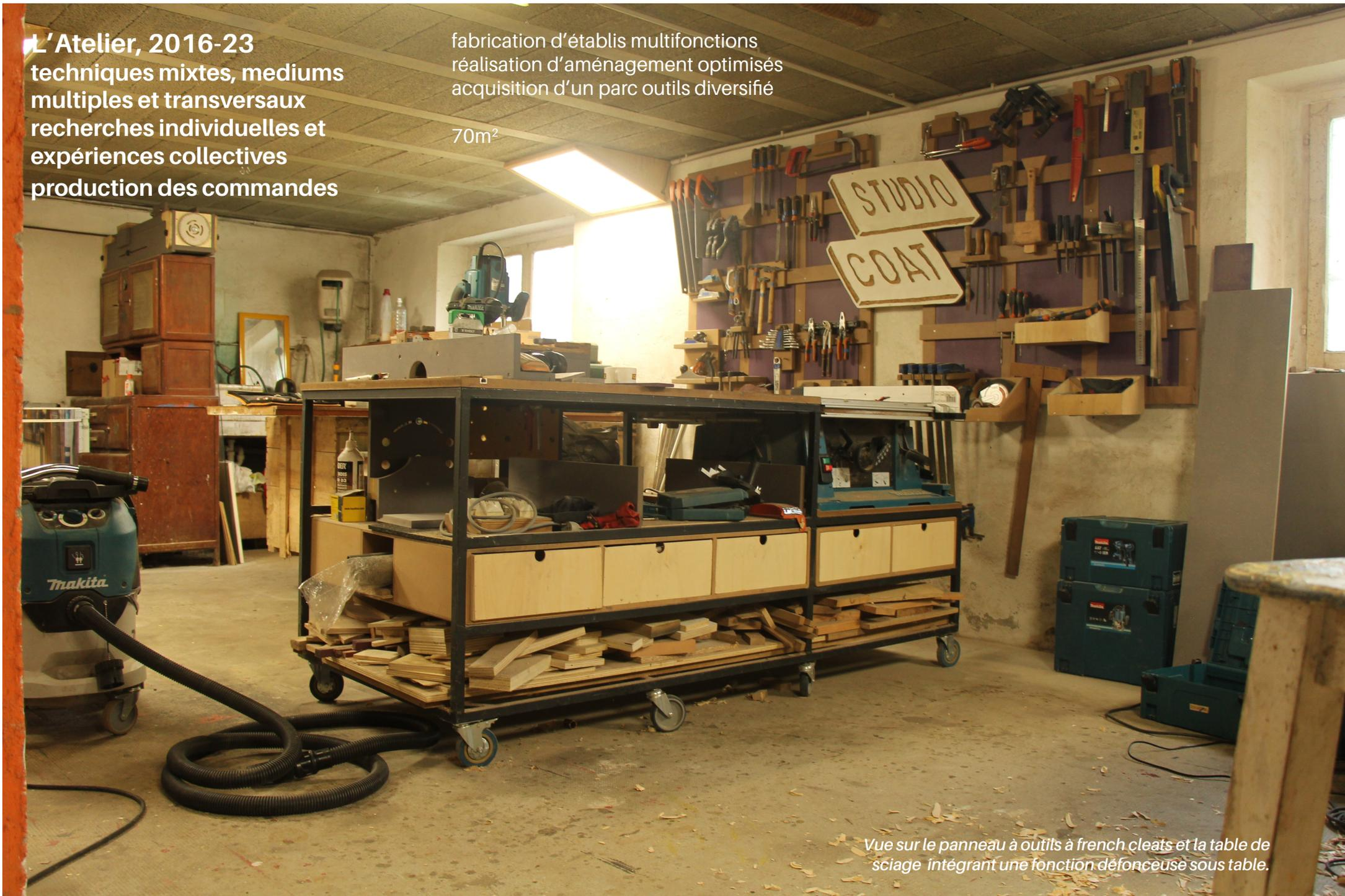
*Vue sur le panneau à outils à french cleats et la table de sciage intégrant une fonction défonceuse sous table.*
